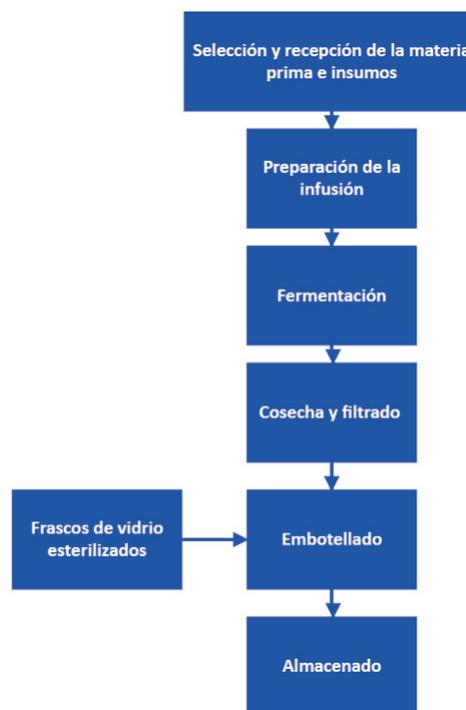
Figura 2 Diagrama del proceso de obtención de la bebida probiótica
