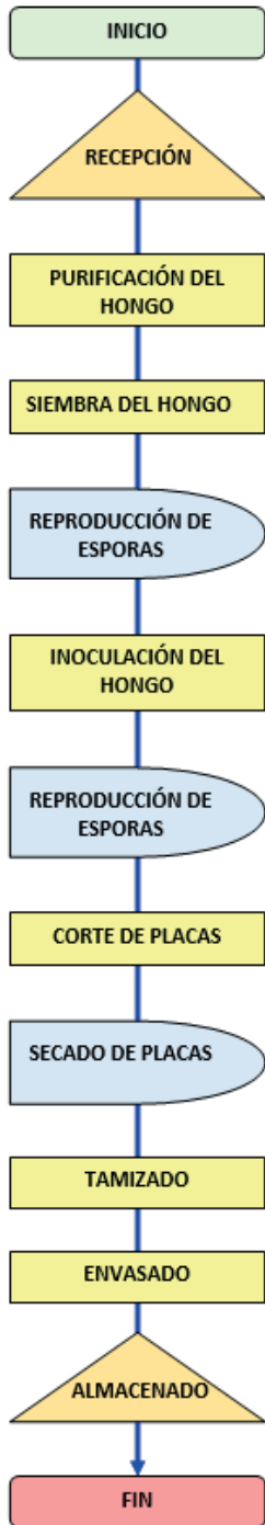
Figura 3. Diagrama de flujo experimental para la obtención del hongo Beauveria bassiana
