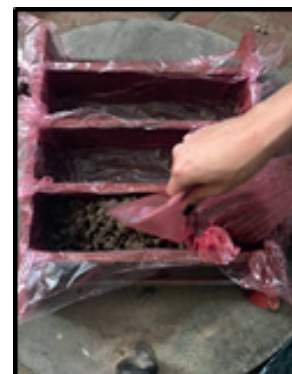
Figura 1: Elaboración del ensayo vigas a flexo-tracción
