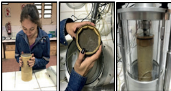
Figura 2: Preparación de probetas para introducir en la cámara triaxial
