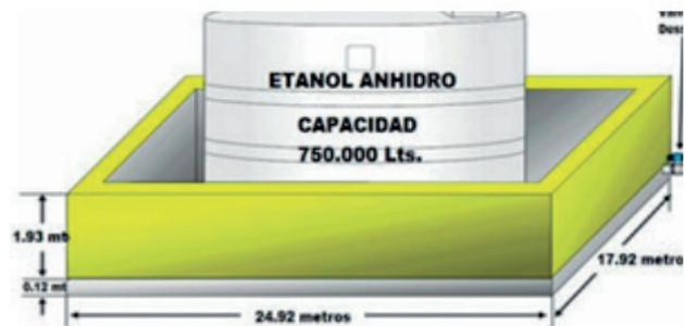
Figura 1. Vista del dimensionamiento del muro de contención de derrames.
