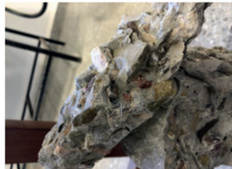
Fig. 2. Mecanismo de falla de probetas patrón.
