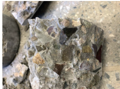
Fig. 3. Mecanismo de falla de probetas de temperatura ambiente + criogénicas.
