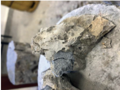
Fig. 4. Mecanismo de falla de probetas de temperatura incrementada + criogénicas.
