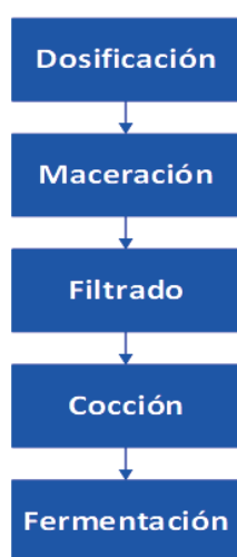
Figura 1. Proceso general para la preparación de la cerveza.
