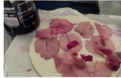
Figura 3. Extracción sólido - líquido en frío de pigmento natural después de 36 horas
